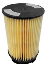
**Wechseln Sie die Filterpatrone** vom ÖlfILTER (Art. Nr. 040104) bei einem zu hohen Unterdruck **kleiner als -0,3 bar**.
