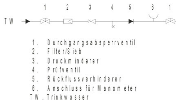
Abb. 15 Anschlussschema Trinkwassereintritt
