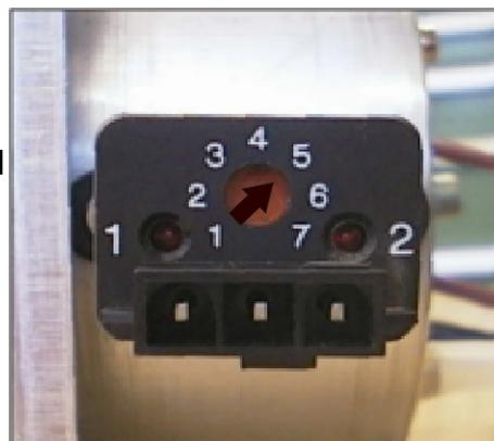
Leuchtdiode 2 zeigt den jeweiligen Schaltzustand des Fühlers an:
