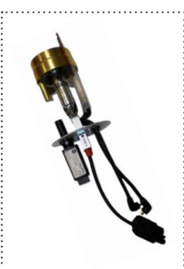
Mischeinrichtung, Öldüse, Zündelektroden mit steckbaren Anschlusskabeln, Ölvorwärmer und Flammenüberwachung sind in einer kompakten Baueinheit zusammengefasst. Ein Bajonettverschluss sichert schnelle, problemlose Servicearbeiten.
